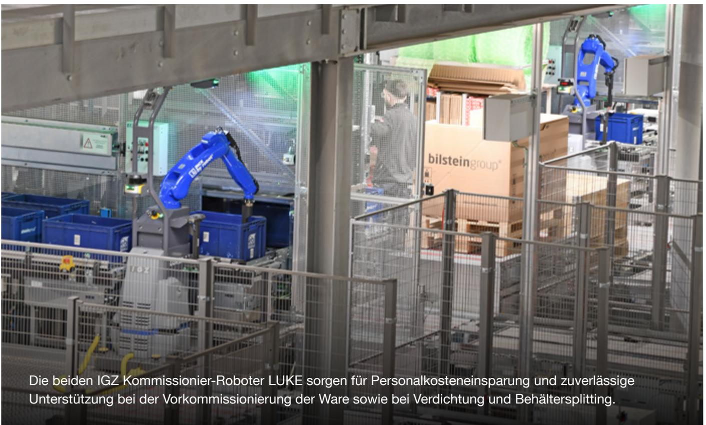
Die beiden IGZ Kommissionier-Roboter LUKE sorgen für Personalkosteneinsparung und zuverlässige Unterstützung bei der Vorkommissionierung der Ware sowie bei Verdichtung und Behältersplitting.
